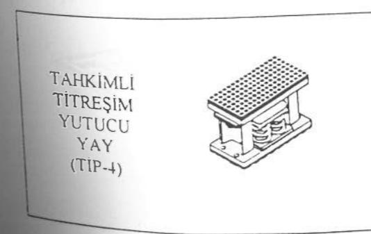
**Not 21 .Tahkimli Titreşim Alıcı Yaylor** : Tahkimli Titreşim alıcı yaylor (Tip-4) üzerinde dikey hareketlerini kısıtlayan civatalara sahiptir. Bu tip yaylor , kazanlar , soğutma makinaları gibi çok değişik ağırlıklara sahip teçhizatın hareketlerinin kısıtlanması ve dış ortamda bulunan ekipmanların rüzgar yükünden dolayı oluşan hareketleri kısıtlamak için kullanılırlar. Seçim kriterleri açık yaylorla aynıdır.Yaylardaki engel ancak gerekli olduğunda geçici olarak devreye girer.
