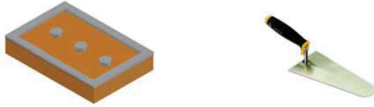
Şekil 4: Isı yalıtım levhalarına ısı yalıtımı sistem yapıştırıcısının uygulanması: Çerçevesel öbekleme metodu
