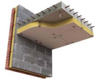
Bir betonarme çatı döşemesinde alev kesici uygulaması
