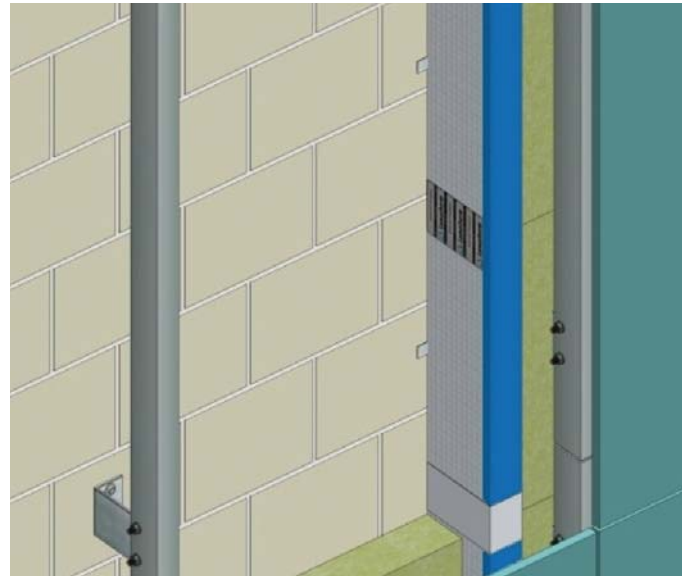
Resim 6: Cephede dikey yangın bariyeri
