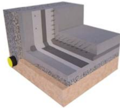
Şekil 15: İçten bohçalama temel yalıtımı 1. aşama (Basıncılı suya karşı)- Isı yalıtımsız
