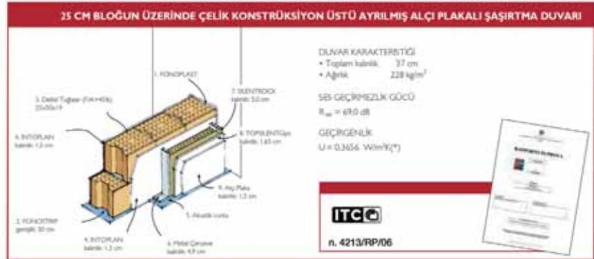
Şekil 7. Ses Yalıtımlı Bölme Duvar Detayı
