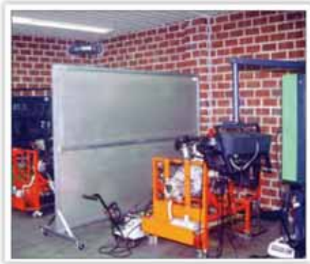
Şekil 9. Motor test atölyesinde ses yutucu elemanların ve ara bariyerin kullanımı
