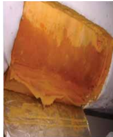
Resim 3: Soğuk hat kullanımında uygulama hatası sonucunda buhar bariyerli kaplamaya rağmen bünyesine nem girişi olmuş ürün
