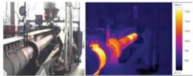
Ekstruder termal kamera görüntüsü ve enerji kayıplarının tespiti
