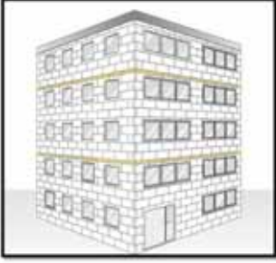
İki katta bir bina çevresinde yanmaz bant uygulaması
