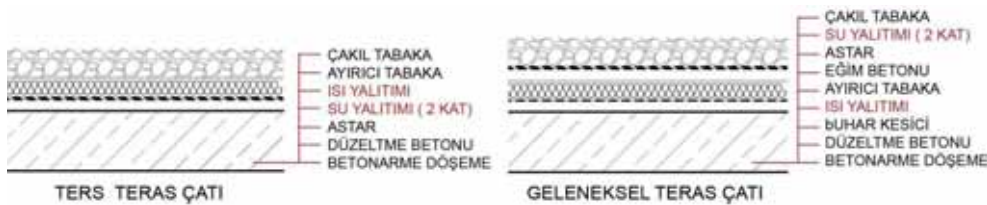
Şekil 5. Ters ve geleneksel teras çatı prensip çizimleri [1]
