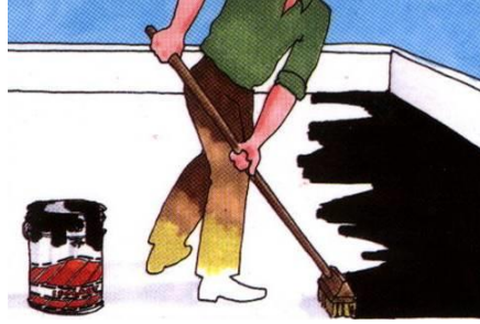
Resim 7: Betonarme yüzeylerin bitüm ile astarlanması
