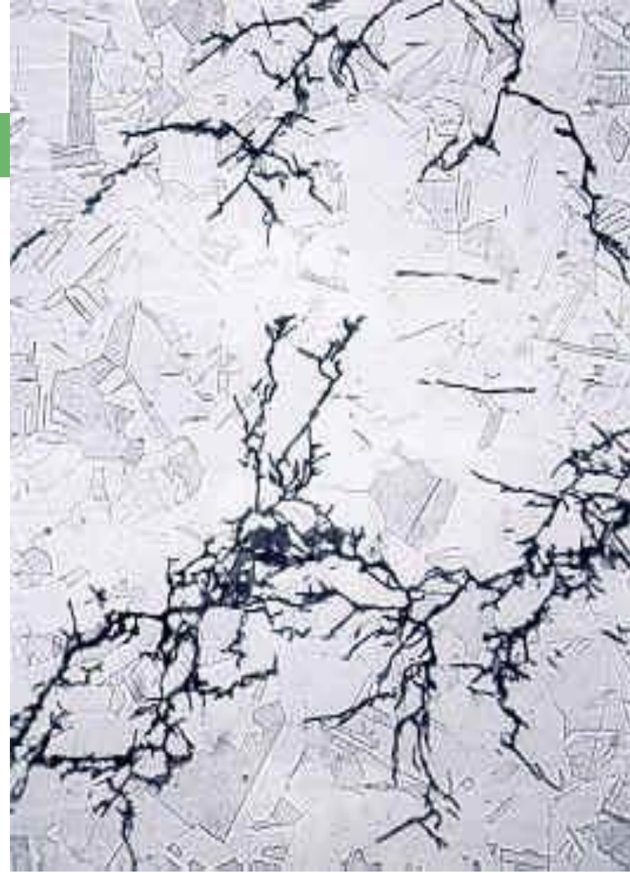
316 paslanmaz çelik kimyasal proses boru sistemi. Östenitik paslanmaz çelikte klorid gerilim korozyonu çatlağı -yıldırım-formunda çatlak oluşumu
