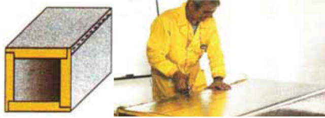
Şekil 32: Kanalların birleşme kenarları üzerinden zımbalanması
