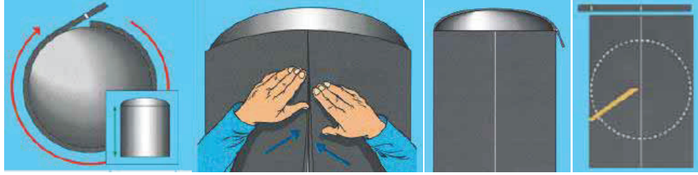
Şekil 59: Şişkin ve yassı elemanların yan yüzeylerinde yapılan yalıtım uygulamaları
