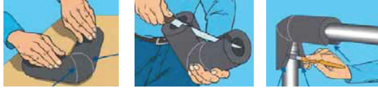
Şekil 48: Mevcut tesisatlardaki çok açılı dirsek uygulamaları
