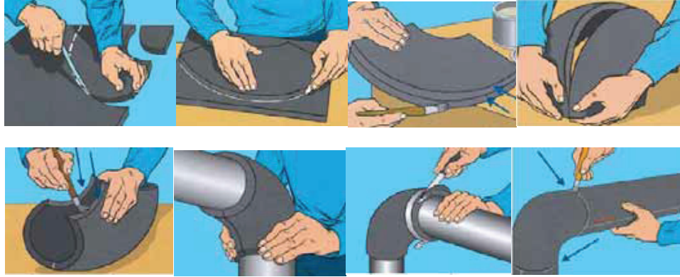
Şekil 57: Dirseklerde yapılan yalıtım uygulamaları
