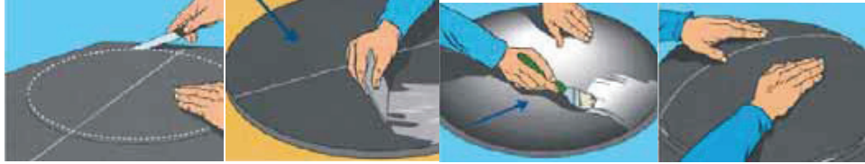
Şekil 60: Şişkin ve yassı elemanların üst yüzeylerinde yapılan yalıtım uygulamaları
