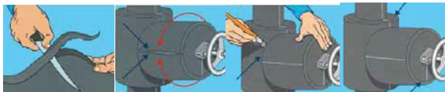
Şekil 69: Vana yalıtımının tamamlanması
