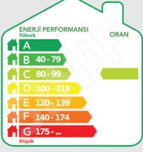
**Yeni binalarda yapı kullanma izin belgesinin alınabilmesi için binanın enerji sınıfının C olması gereklidir. Binaların enerji sınıflarının C olabilmesi için yukarıdaki tabloda verilen kalınlıklarda ısı yalıtımı yapılmalıdır**
